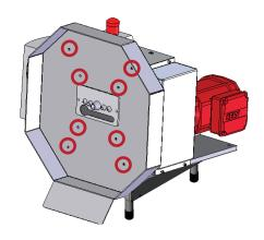
STEP 2: **REMOVE FRONT CUT PLATE**
